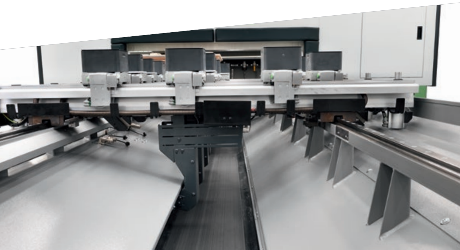
Моторизованная лента для отвода стружки.
