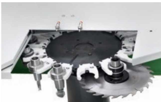
Инструментальный магазин револьверного типа на 13 или 16 мест.
