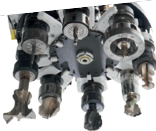
Инструментальный магазин револьверного типа на 8 мест.
