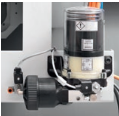
Система автоматической смазки сверлильной головы BHZ 29 2L.
